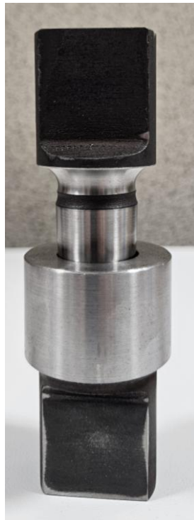
Rysunek 2. Zdjęcie przedstawiające sposób realizacji stożkowego połączenia właczanego
