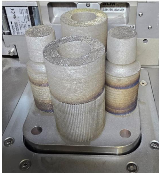
Rysunek 1. Zdjęcie przedstawiające elementy stożkowego połączenia właczanego wytworzone techniką przyrostową SLM
