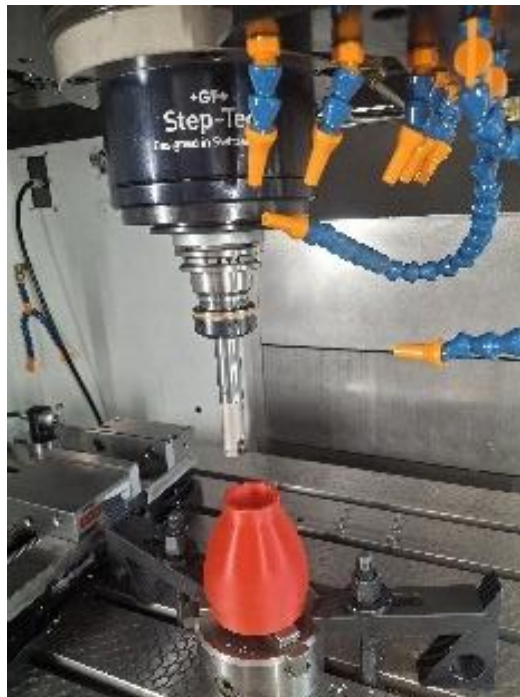
Rysunek 2. Prototyp podczas obróbki kształtowej na frezarce CNC
