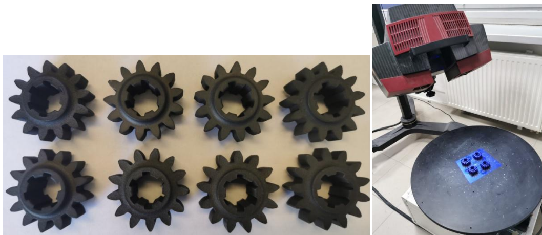
Rysunek 1. Modele 3D badanych kół zębatach (a), pomiary na skanerze Atos II Triple Scan (b)
