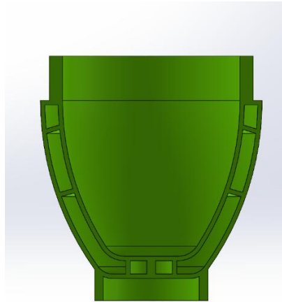
Rysunek 1. Przekrój modelu cienkościennego zaprojektowanego w CAD 3D
