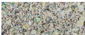
Rozdrobnione płytki elektroniczne -2 +0,5 mm Metale nieżelazne - 20,00%, Włókno szklane - 80,00%
