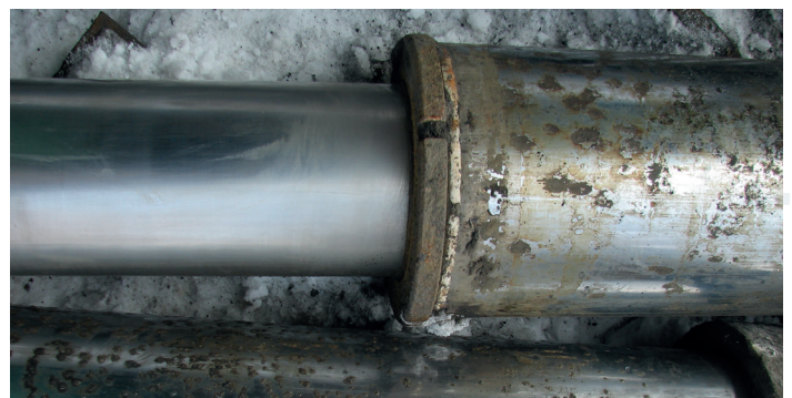
↑ Górniczy stojak hydrauliczny z powłoką DURACHROM na tłoczysku (z lewej) i standardową powłoką ochronną na rdzenniku (z prawej) po dwuletniej eksploatacji w kopalni węgla kamiennego.
