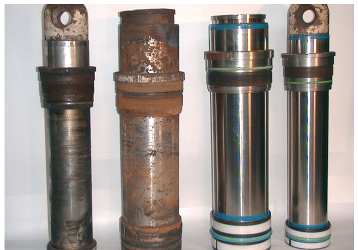
↑ Rdzenniki stojaka hydraulicznego przed i po regeneracji z zastosowaniem powłoki DURACHROM i uszczelnień produkcji FAMUR.
