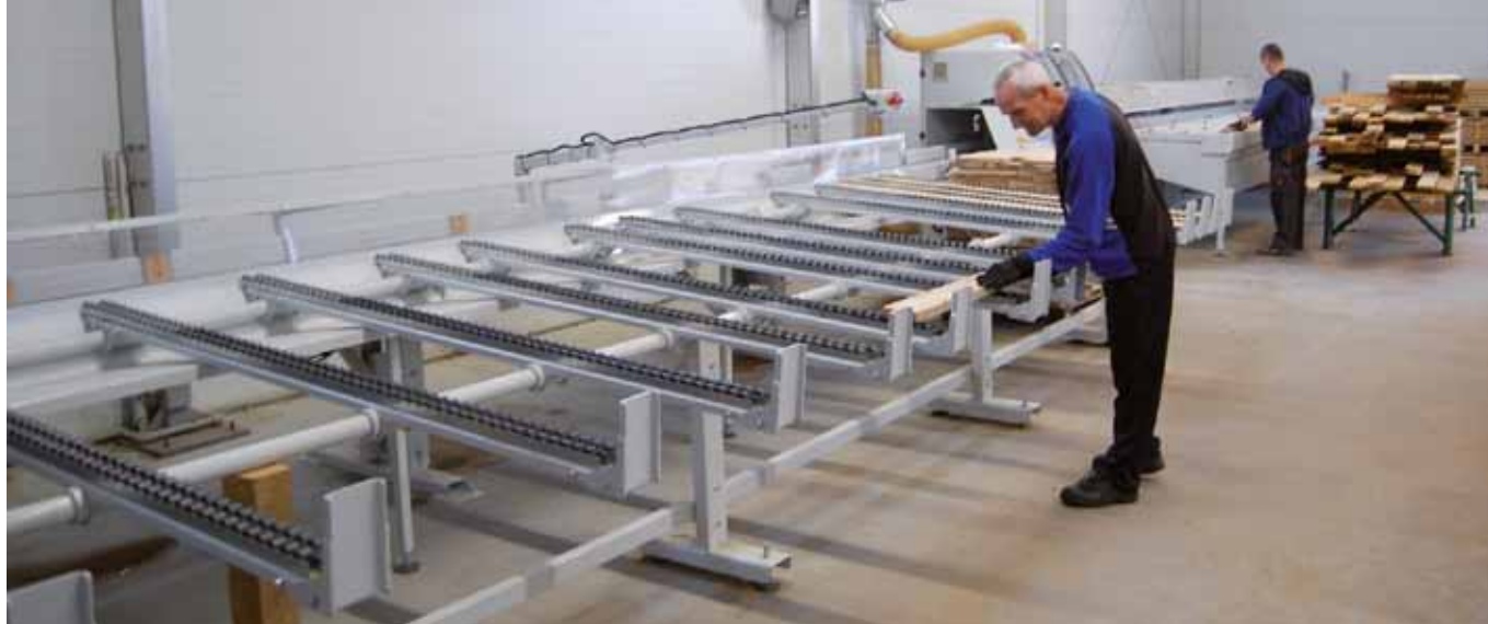
Na stole rolkowym elementy o różnych wymiarach nie mieszają się, bo są spychane w odpowiednich miejscach przez odbojniki.
