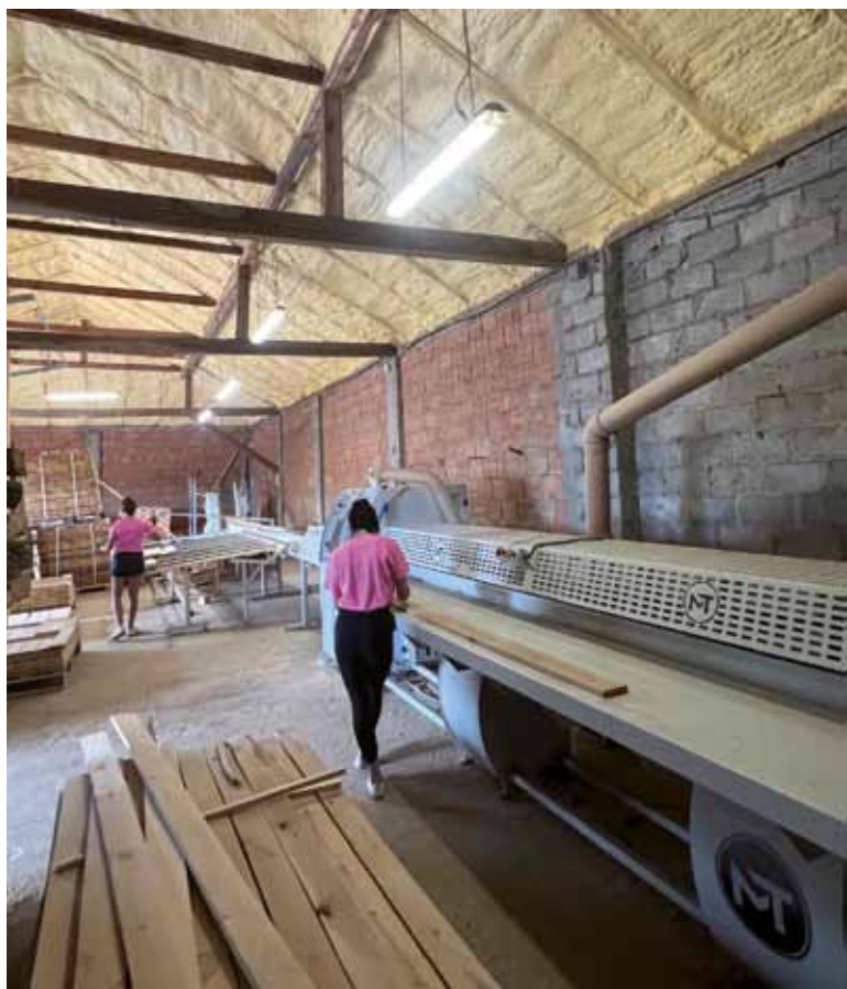
Stół podawczy jest standardowy z ręcznym załadunkiem materiału, ale pozostałe sekcje, czyli tnąca i odbiorcza są maksymalnie wyposażone.
