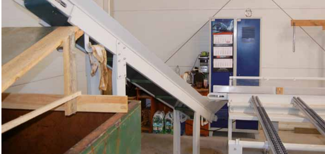
Przenośnik zrzuca wadliwe kawałki do kontenera wewnątrz hali.
