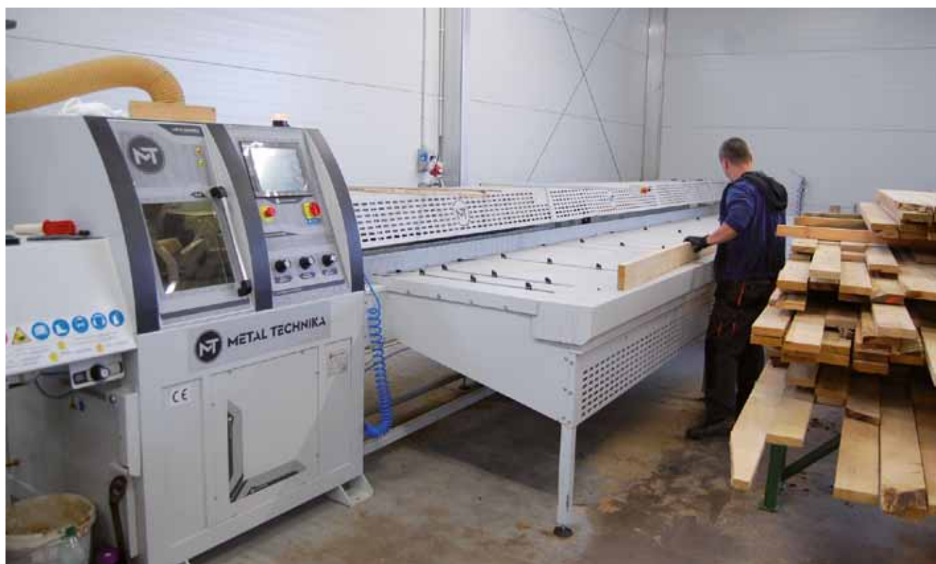
Stół buforowy zwiększa płynność pracy nie tylko maszyny, ale też operatora.
