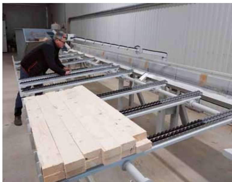
Bardzo ważną rolę odgrywa również system odbiorczy. Jest to taśmociąg z sześcioma pneumatycznymi wyrzutnikami sterowanymi przez fotokomórki.
