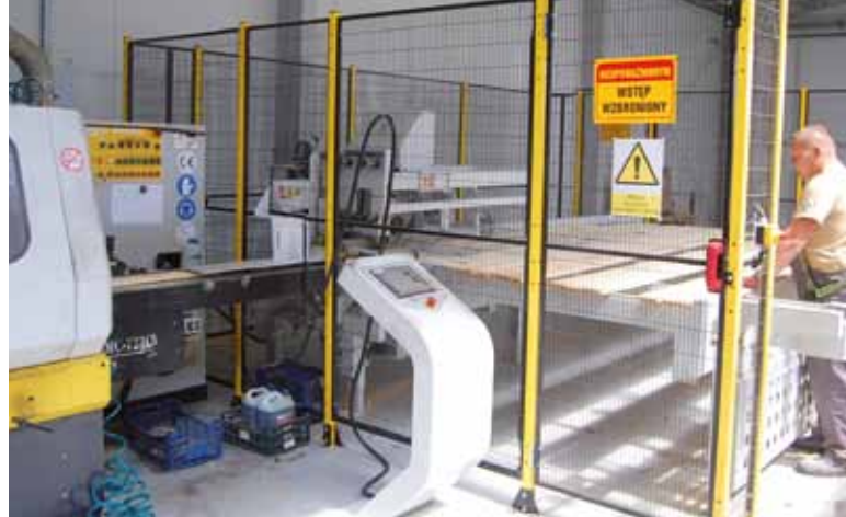
Przed strugarką Leadermac Compact 723 dostawiono wykonany przez Metal-Technikę szeroki podajnik listew z buforem. fot. Janusz Bekas
