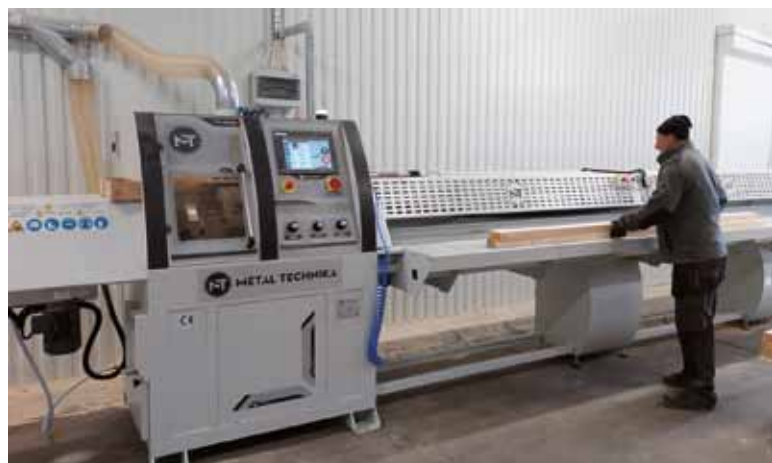
Maszyna sama reguluje prędkość podawania, sygnalizując, kiedy na stole można umieścić następny element lub pakiet elementów.
