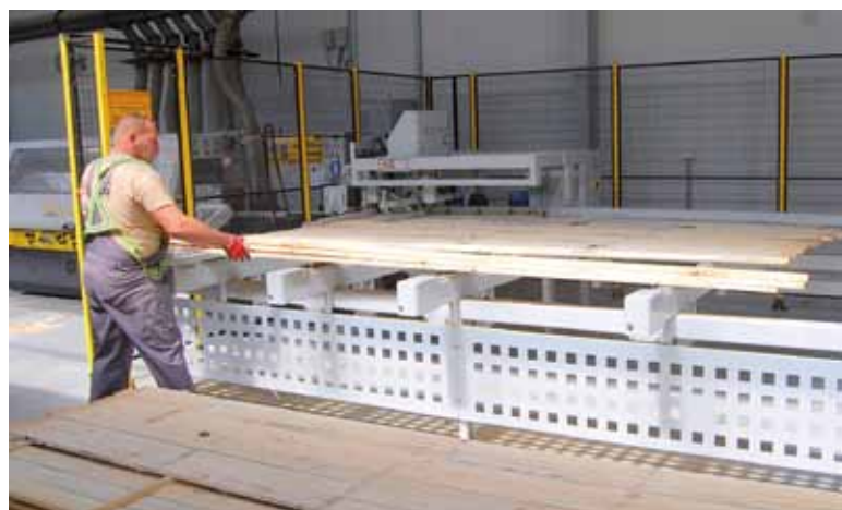
Okolo 20 listew spoczywa na przenośniku buforu, z którego automatycznie kolejne z nich trafiają na przenośnik taśmowy, przenoszący je do modułów obróbkowych strugarki. fot. Janusz Bekas
