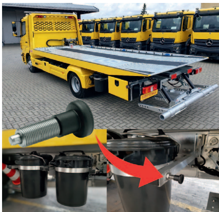
Rys. 2. Blokada pojemników za pomocą trzcienia ustalającego GN 613-NI
