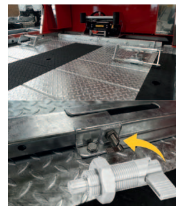
Rys. 3. Blokada kół za pomocą trzcienia GN 612-NI
