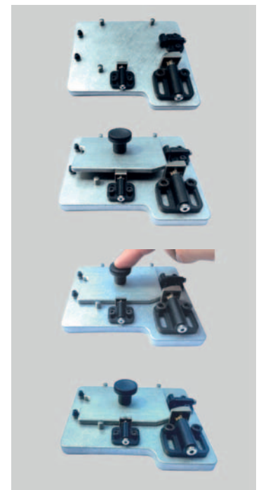
Rys. 4. Szybki montaż płytki za pomocą docisków GN 415
