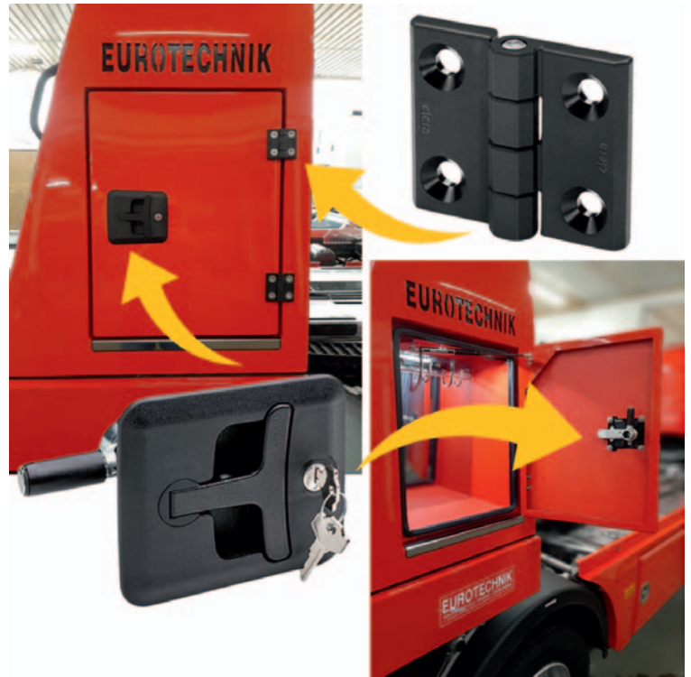
Rys. 6. Skrzynia narzędziowa z zawiasem CFM i zamkiem CSMH
