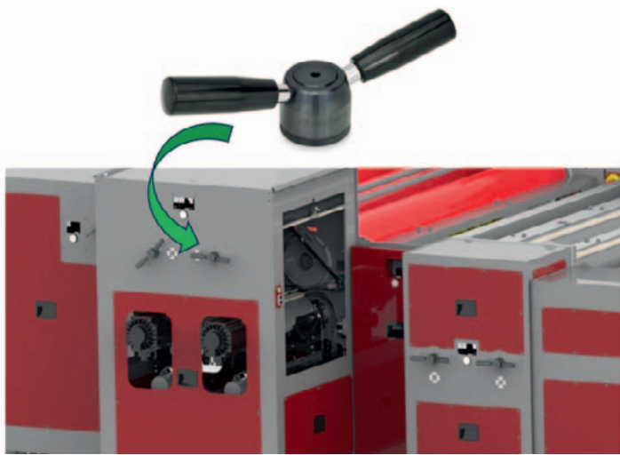
Rys. 6. Mechanizm pozycjonujący GN 200 w maszynie do produkcji opakowań z tektury
