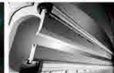
Hydrauliczne mocowanie stempli i matryc Wila
