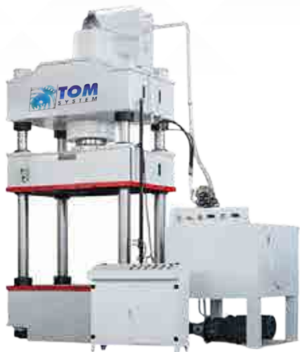
Konstrukcja trzybelkowa czterokolumnowa
