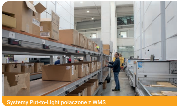
Systemy Put-to-Light połączone z WMS
