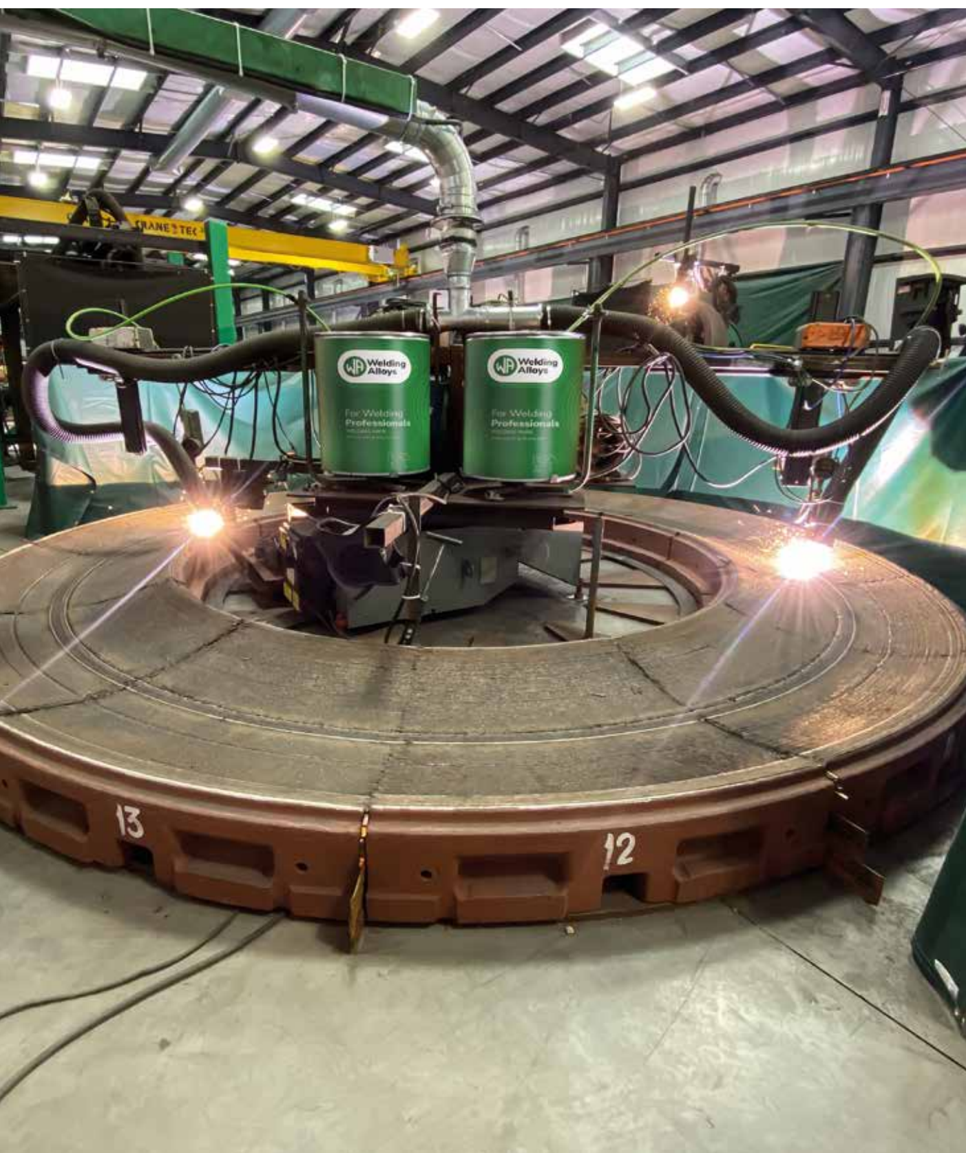
Napawanie misy młyna cementu żeliwem wysokochromowym.
