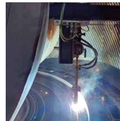
Cementownie: napawanie misy mielącej
