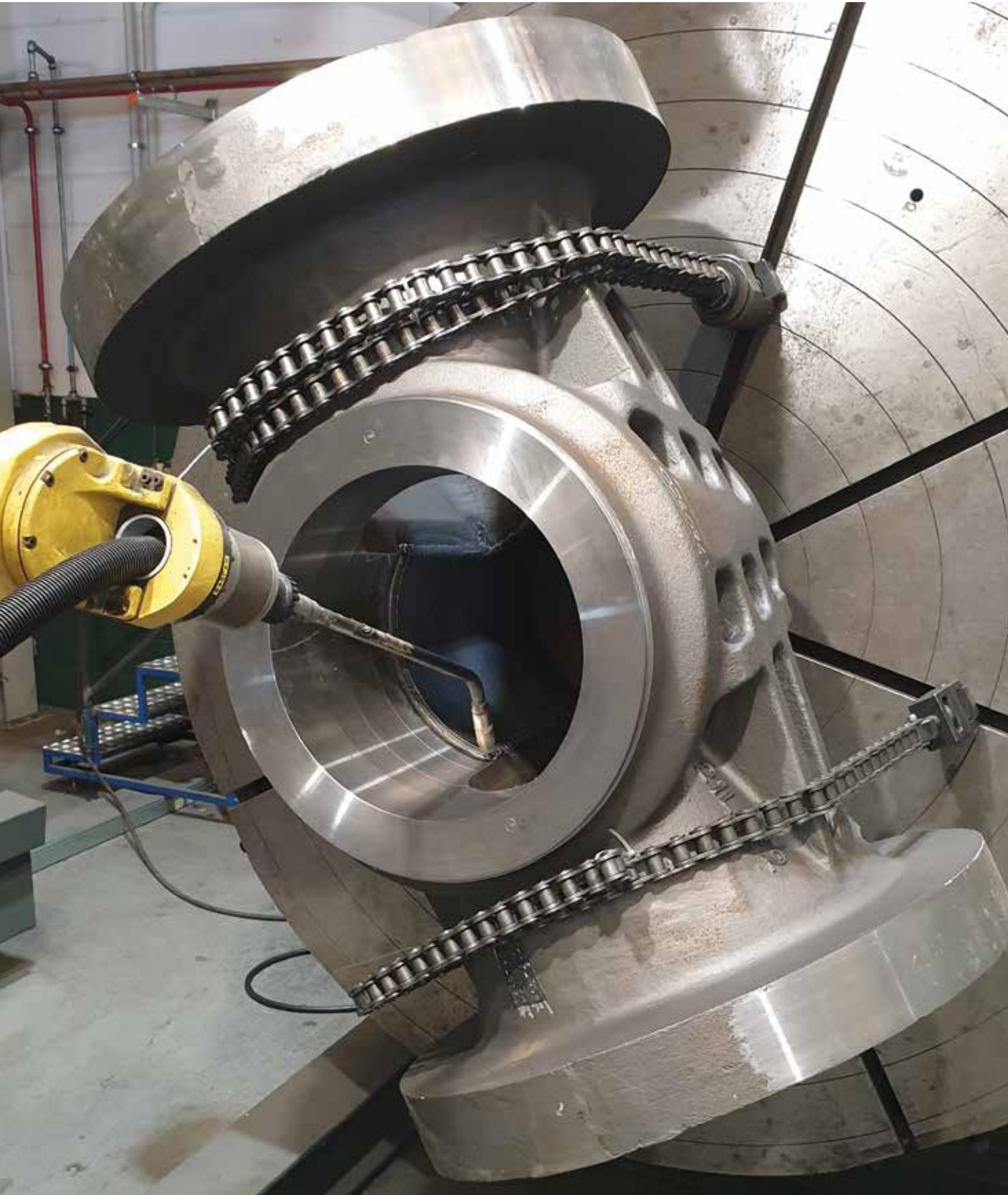
Zawór napawany drutem STELLOY 21-G przy użyciu robota spawalniczego.
