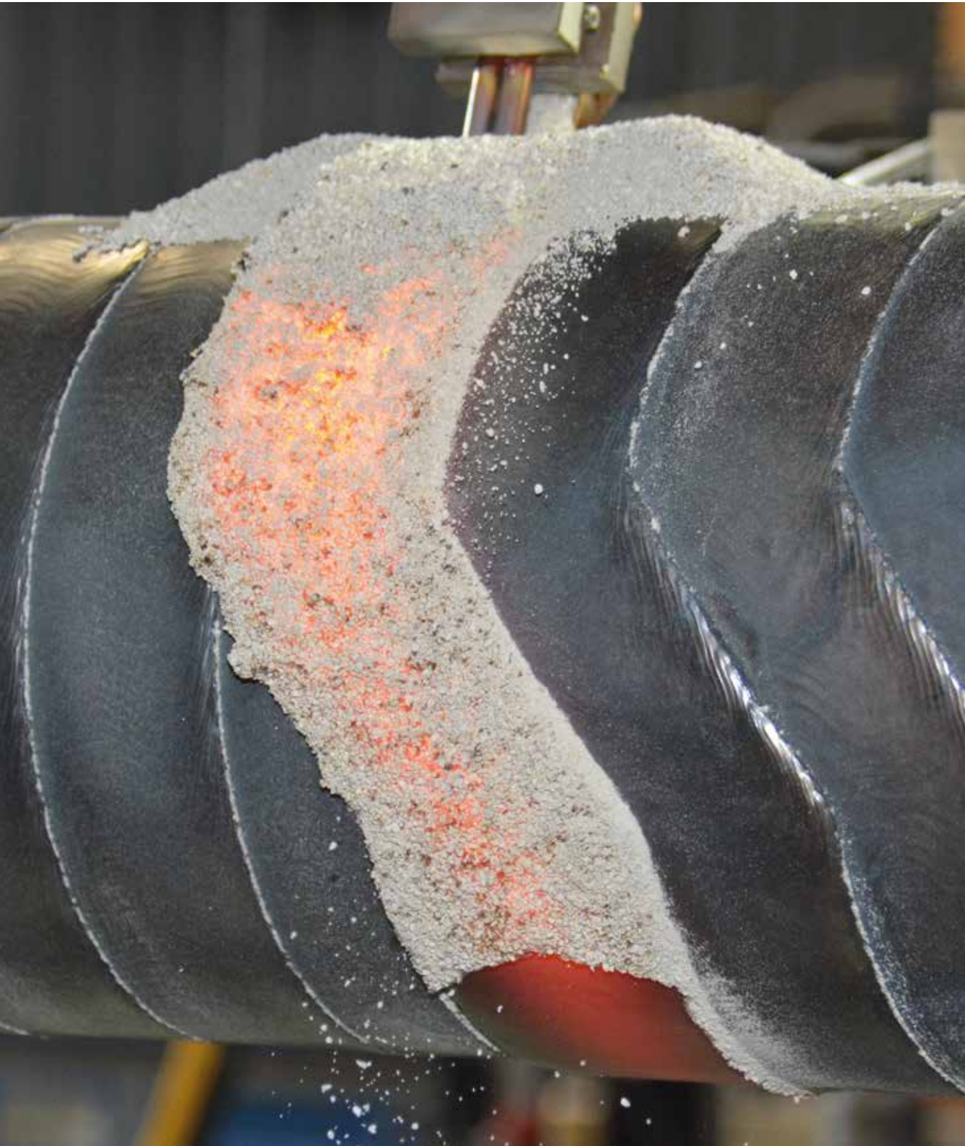
Zautomatyzowane napawanie łukiem krytym przy użyciu naszej maszyny Roll Cladder i drutu rdzeniowego CHROMECORE.
