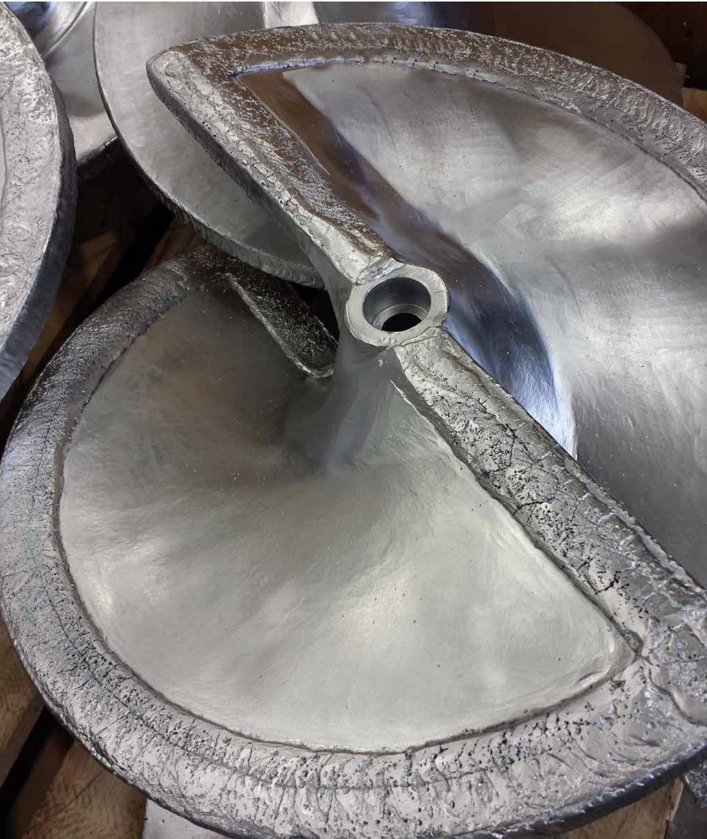
Napawanie pióra ślimaka przy użyciu HARDFACE STAINCARBW
