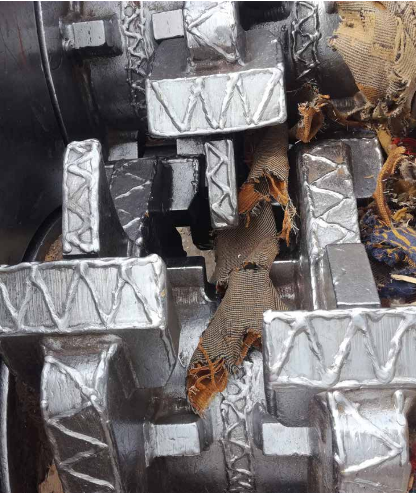
Napawanie rozdrabniacza drutem HARDFACE L-O. Prace wykonywane przez Welding Alloys w zakładzie Klienta.
