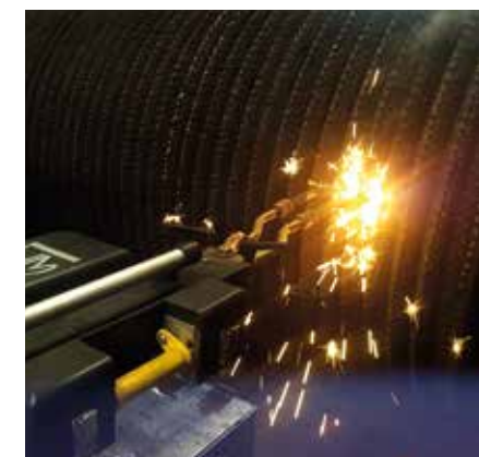
Cukrownie: napawanie rolki rozdrabniającej
