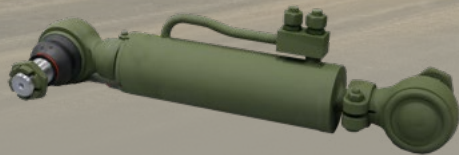
① 실린더 조립체, 조향장치용 Steering Cylinder Assembly
