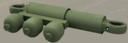
② 유기압 현수장치 Hydro-Pneumatic Suspension Assembly
