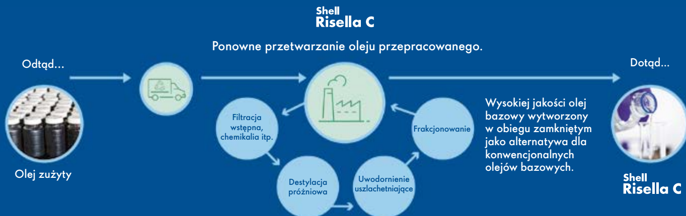
Rysunek 3: Shell Risella C powstaje w wyniku przetworzenia olejów przepracowanych w czteroetapowym procesie.
