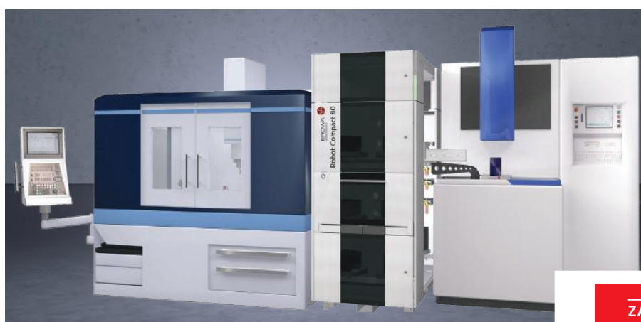
Robot EROWA Compact 80 pomiędzy maszyną EDM a centrum frezarskim.
