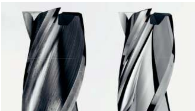
Narzędzie skrawające przed i po obróbce
