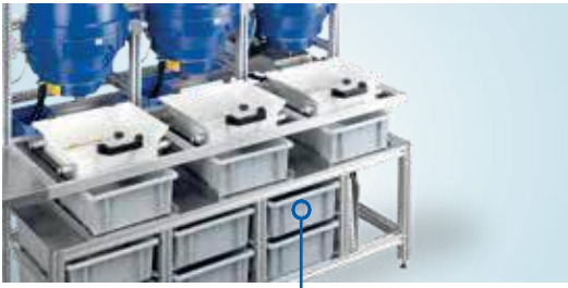
Magazyn wsadów z pojemnikami plastikowymi na dodatkowe rodzaje ścierniw
