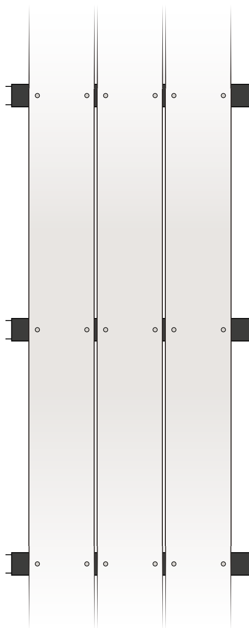
Podwójne mocowanie z wykorzystaniem wkrętów Cedral o dopasowanych kolorach lub gwoździ żebrowanych ze stali nierdzewnej
