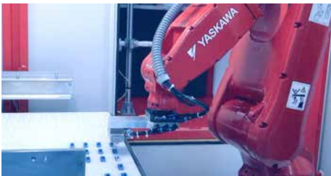
Robot podnoszący implant z tacy
