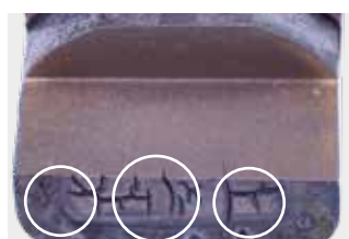
Pęknięcia w głąb Cracks in depth
