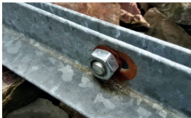
Ocynkowana podkładka i nakrętka ze stali nierdzewnej stworzyły niekorzystną relację powierzchniową (źródło: OBO Bettermann)
