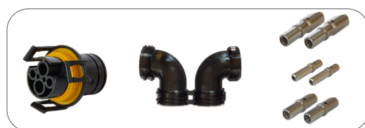
Zestaw wtyczek 4P dla IBBC: 1x wtyczka 4P, ECU/przelotka po stronie ciągnika, kontakty toczone 2x 2,5 mm 2 , 2x 10,0 mm 2 , 2x 16,0 mm 2 , obudowa przyłącza rury falistej dla NW19 (wyjście 90°) 4P plug set for IBBC: 1x 4P connector, ECU/Pass-Through on tractor side, contact sleeves 2x 2.5mm 2 , 2x 10.0mm 2 , 2x 16.0mm 2 , corrugated tube cap for NW19 (90° out)
