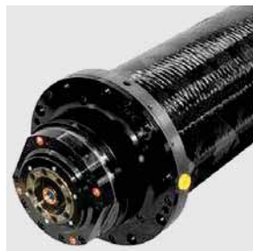
Wrzeciono Step-Tec: 120 Nm, 20 000 min -1
