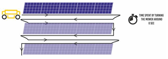
MOWING STYLE UNDERNEATH AND AROUND THE GROUND-FIXED
