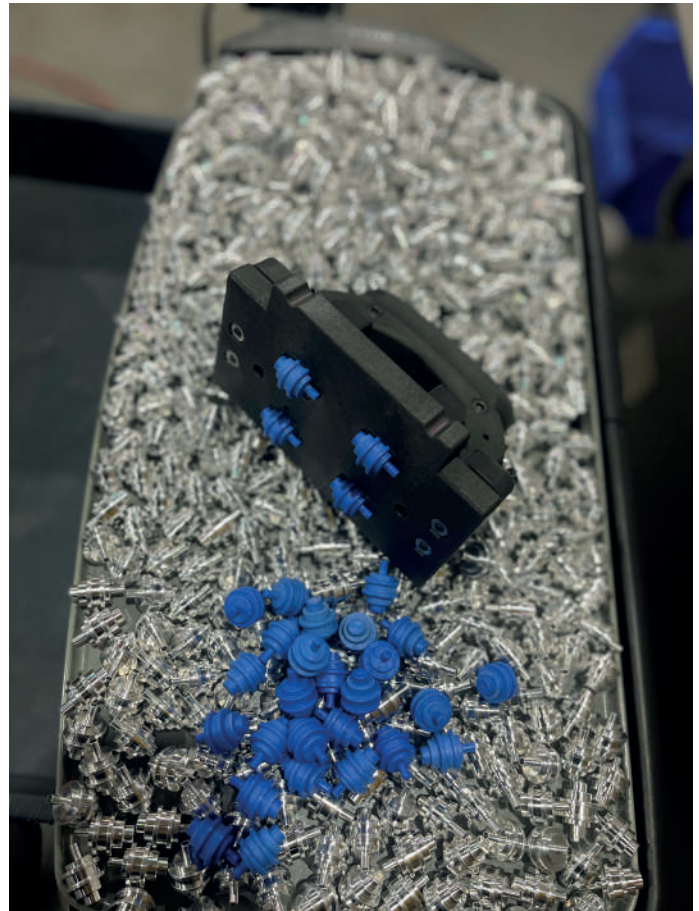
Niestandardowe narzędzie używane do ręcznego umieszczania mosiężnych wkładek we wtryskarce.
