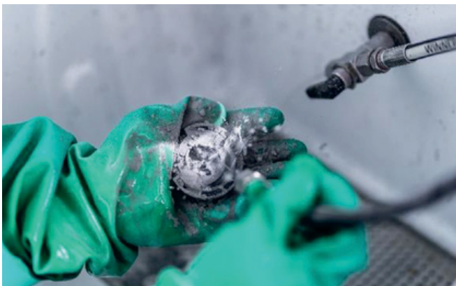
Depowdering za pomocą strumienia wody
