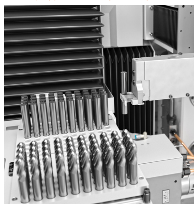
////////// PODTRZYMKĄ Z AUTOMATYCZNYM POSUWEM zapewnia optymalny rezultat szlifowania w przypadku dłuższych narzędzi
