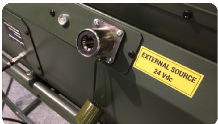
Gniazdo po montażu w pojeździe Socket as installed at a vehicle
