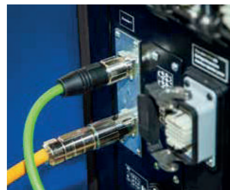
Serwokabel - Podłączenie kabla silnika i enkodera bezpośrednio do jednostki sterującej
