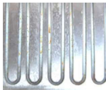
Pokryte kanały po 230 godzinach testów zraszania roztworem solnym z minimalną korozją
