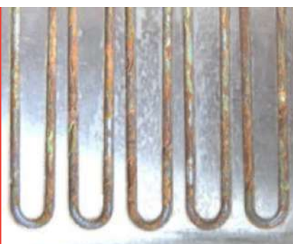
Kanały niepowlekane po 230 godzinach próby zraszania (roztwór NaCl zgodnie z normą DIN EN ISO 9227) z silną korozją
