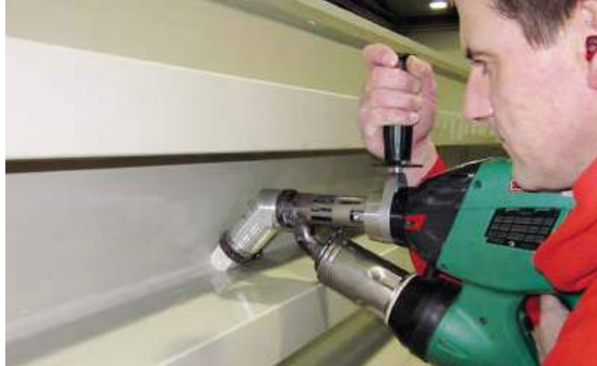
WELDPLAST S2 z przedłużką kątową
