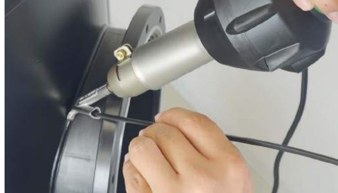
Spawanie elementu z PP
