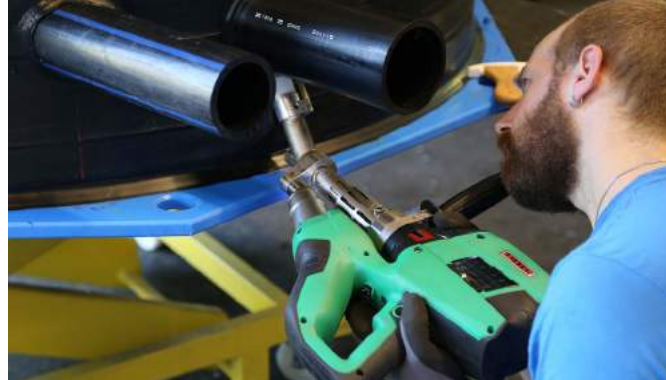
Spawanie z użyciem przedłużki kątovej 45°
