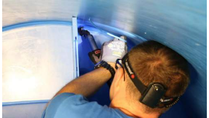
WELDING PEN to idealne rozwiązanie do produkcji zbiorników
