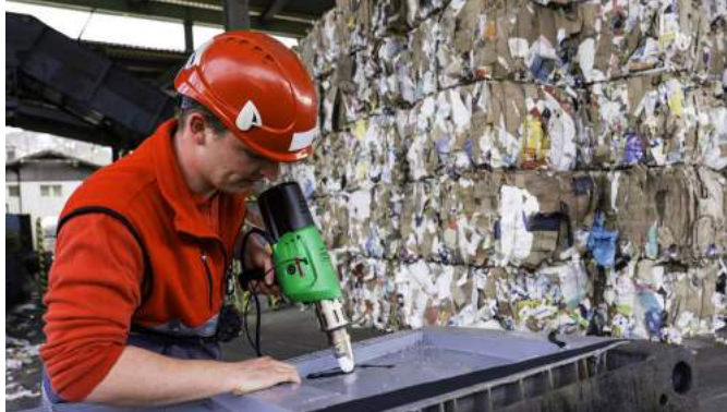
FUSION 1: naprawa pojemników transportowych.
