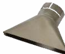
Dysza szybkiego spawania do drutu profilowego bez końcówki do łączenia wstępnego, gwint M14 \nabla 5,7 x 3,7 Nr zamów. 5113877 \nabla 7 x 5 Nr zamów. 5106986
