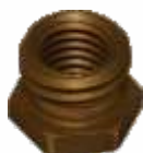
Adapter mit Gewinde M14 auf M10 Best.-Nr. 5201015
