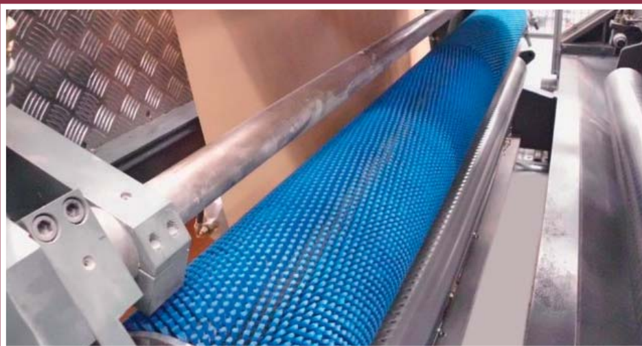
BSW215 per cambio bobina automatico nel gruppo incollatore / taglio
