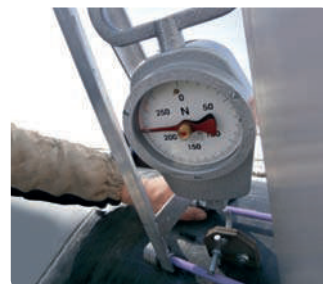
Test przyczepności rękawa ANTICORRay® WSS60
