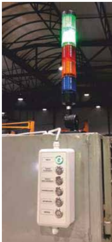
Przykładowe zdjęcie wieży sygnalizacyjnej zintegrowanej z Golem CNC oraz panelem statusowym Industrial.
