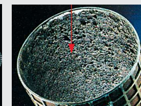
Uszkodzenie powstałe w wyniku starzenia się oleju
