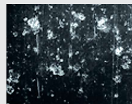
Łożyska zniszczone przez wżery (pitting)
