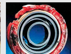
Uszkodzenie uszczelnienia łożyska przez tzw. efekt mikro-diesel
