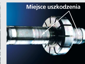
Wał uszkodzony przez erozję
