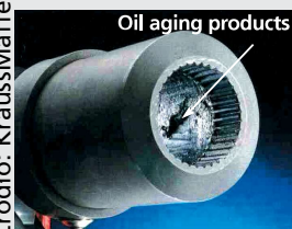
Uszkodzenie sprzęgła powstałe w wyniku starzenia się oleju
