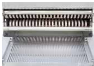
System drenażowy w sposób kontrolowany odprowadza resztki płynów
