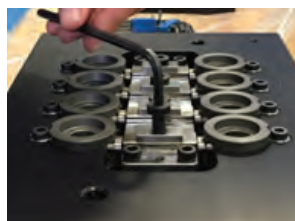
KROK 1 Usunąć śrubę i prostokątną wkładkę
