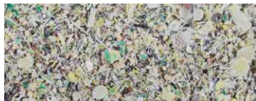
Rozdrobnione płytki elektroniczne -2 +0,5 mm Metale nieżelazne - 20,00%, laminat szklany - 80,00%
