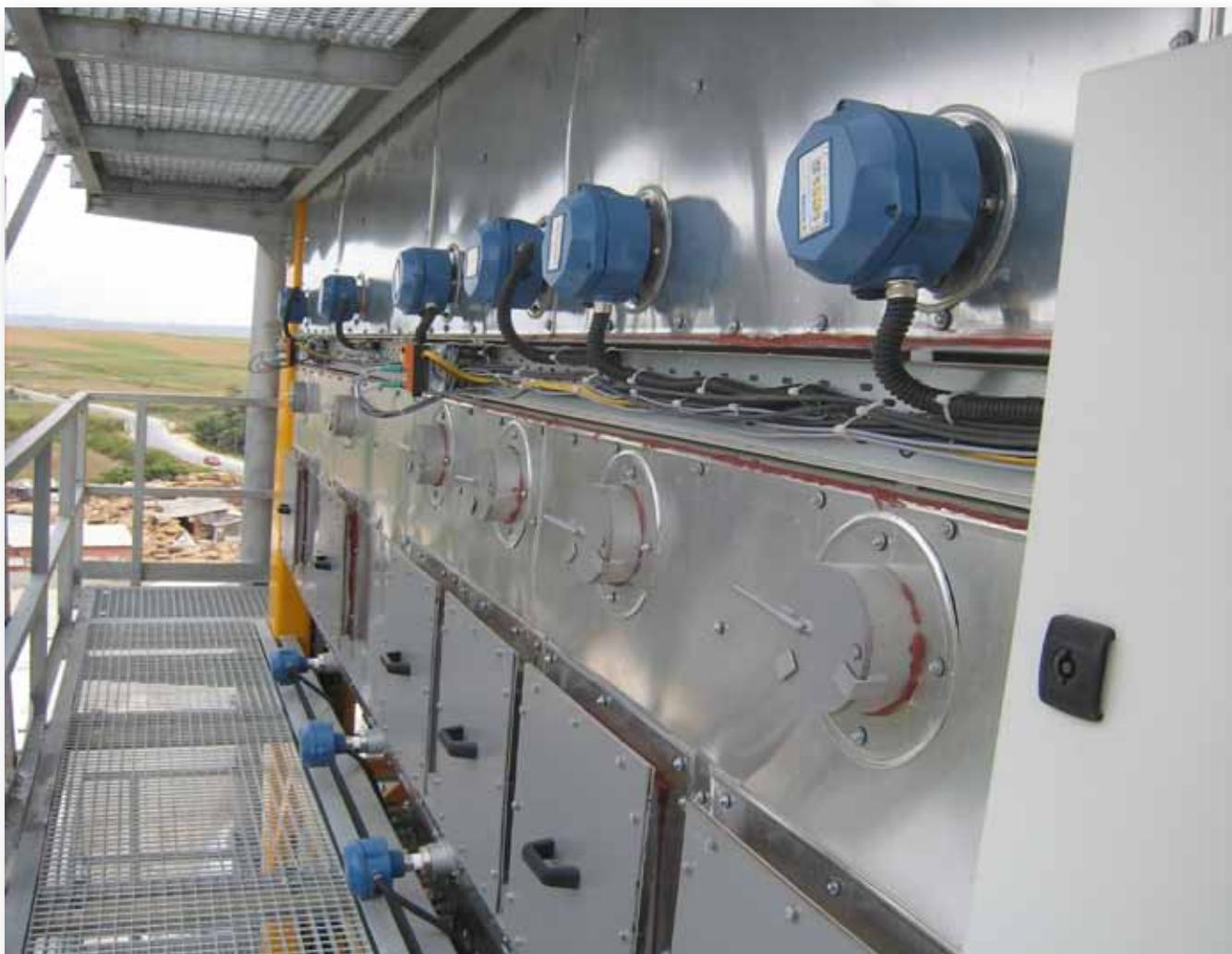
Agrega, bitüm ve filler kantarlarının her birinde üç adet yük hücresi (load cell), vibrasyon önleyici kauçuk takoz ve özel sınırlayıcı bulunmaktadır ve bu sayede hassas ve hızlı tartım garanti edilmektedir.
