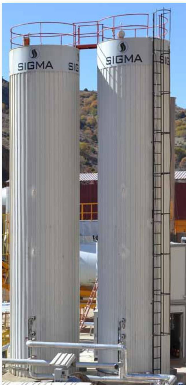
70 m<sup>3</sup> elektrikli ısıtmalı dikey bit m tankları
