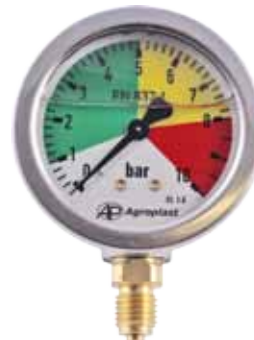
Manometr glicerynowy 221254 Mocowanie: M12 x 1,5 (dolne) Płyn wypełniający obudowę: gliceryna 99.7% Podziałka: od 1 do 10 bar co 0,2 bar Klasa dokładności: 1.6 Zastosowanie: zawory sterujące opryskiwacza
