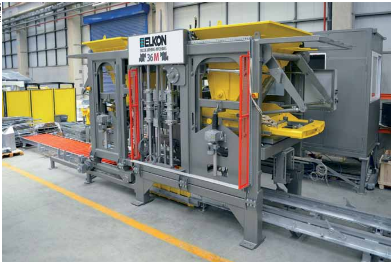
Wibroprasa Elkon ELKOBLOCK-36M. Została zaprojektowana do produkcji kostki brukowej, bloczków krawężnikowych, płyt ażurowych, przepustów, odwodnień itp.
